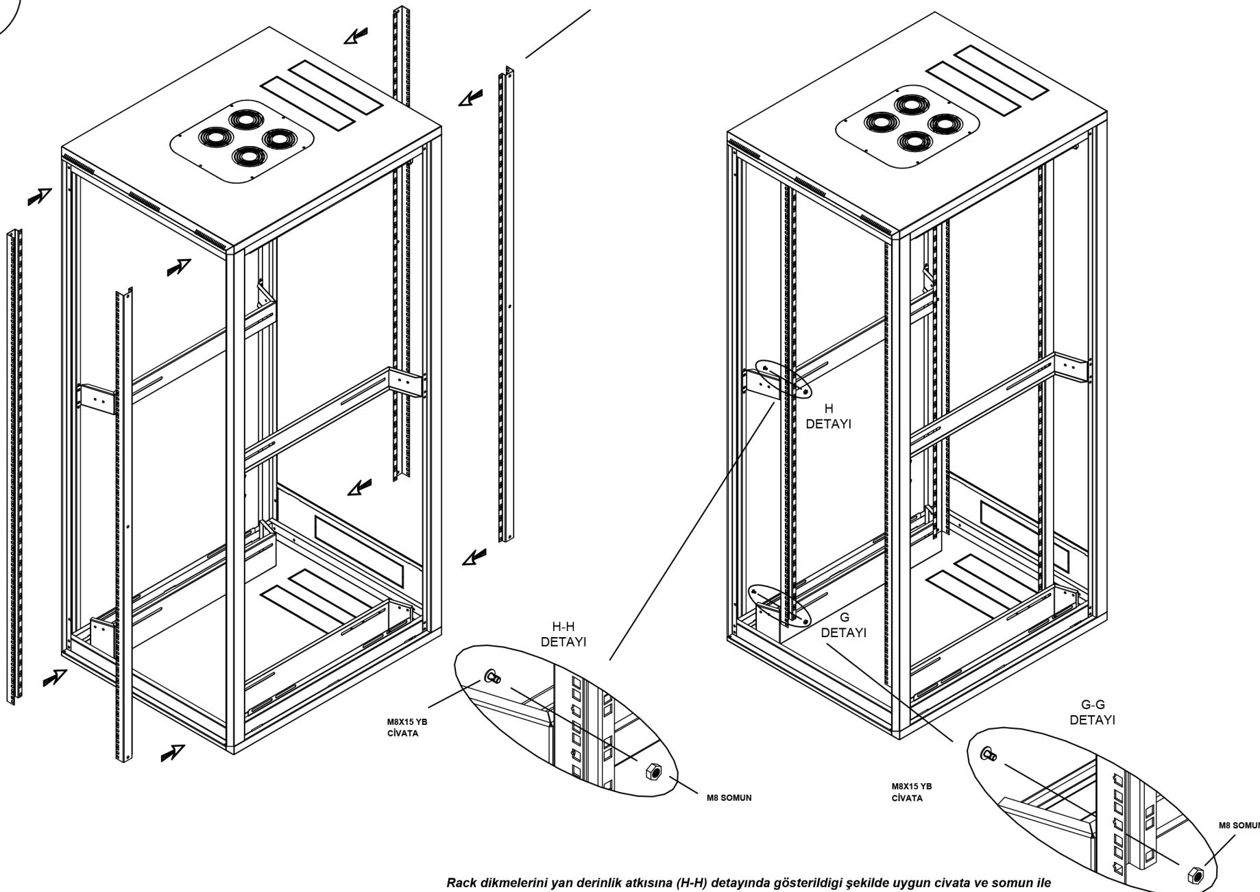
Rack dikmelerini yan derinlik atkısına (H-H) detayında gösterildiği şekilde uygun civata ve somun ile vidalayınız. Diğer köşelerde aynı işlemi uygulayınız.
