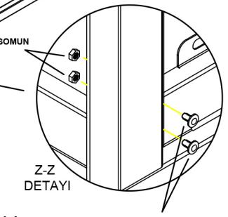
Dört adet dikmeyi (Y-Y VE Z-Z)detaylarında gözüktüğü gibi tek tek alt tabana vidalayınız.
